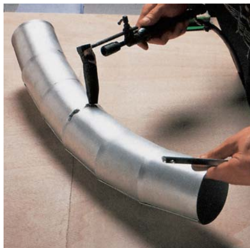
Letování článkového ohybu a rohové části žlabu.
